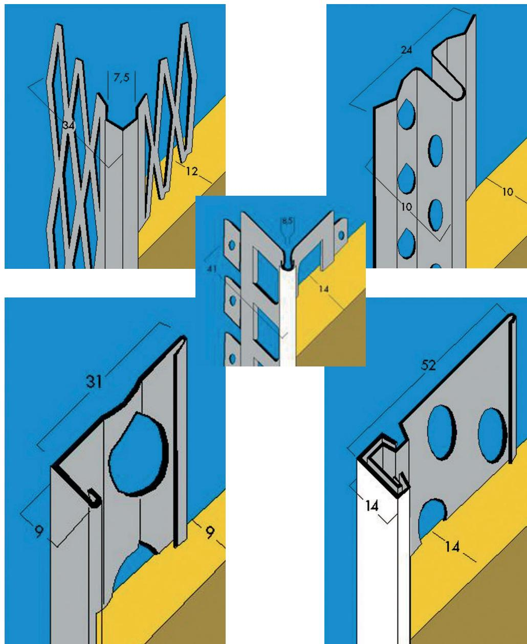
**Putzprofile:** Da die Zusammensetzung bzw. chemischen Eigenschaften der verwendeten Putze ausserhalb unserer Einflussmöglichkeiten liegen, kann die Beständigkeit unserer Profile gegen Korrosion nicht garantiert werden. Wir schlagen Ihnen vor, wo es möglich ist, Edelstahl-Putzprofile zu verwenden. Durch Eigenversuche erreichen Sie die beste Sicherheit gegen mögliche Fehler, für die wir keine Haftung übernehmen können.
