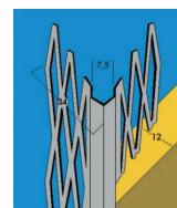
Werkstoff: Stahlblech mit einer Zinkauflage von 275 gr/m<sup>2</sup>. Scharfkantiges Putzprofil für 12mm Putzstärke Schenkelbreite 34mm
