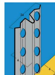
Werkstoff: Stahlblech mit einer Zinkauflage von 275 gr/m<sup>2</sup>. Schnellputzprofil für 6mm Putzstärke
