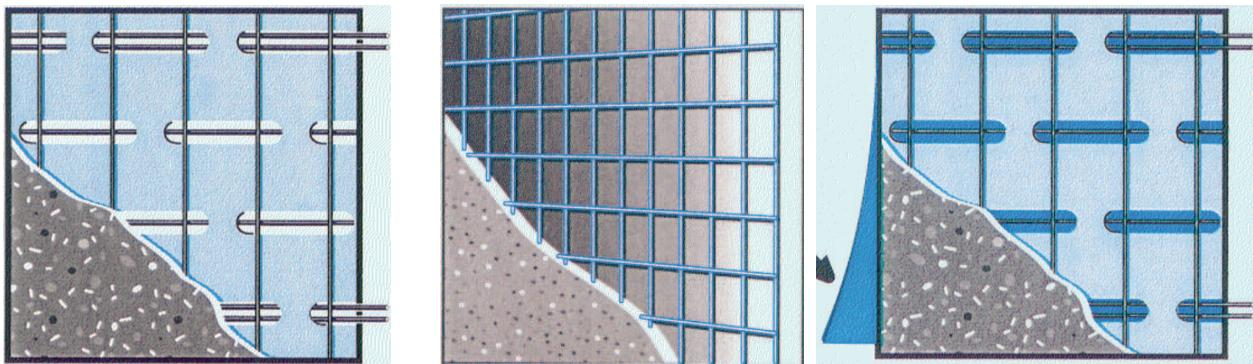
**Putzarmierungsgitter (Putzträger):** Diese Drahtgitter werden als Armierung für mineralische Putze im Bereich rissegefährdeter Zonen eingesetzt. Neben der Armierungsfunktion haben sie auch noch eine putztragende Funktion. Das Drahtgitter wird vor allem für das vollflächige Überspannen von gerissenen Fassaden verwendet.
