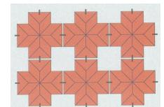
Werkstoff: Drahtgewebe mit gebrannten Tonkörpern
