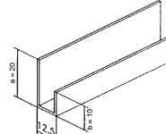
Anwendung: Kantenschützer werden im Trockenausbau verwendet z.B. bei Gipskartonplatten.
