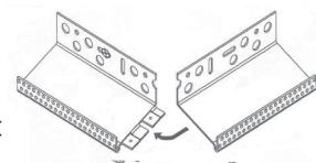
Anwendung: Einsatzzweck wie Alu-Sockelprofile mit Tropfkante jedoch zusätzlich mit Stoßverbinder. Der vorgeprägte Stoßverbinder sorgt für saubere und gerade Verbindungen – daher entfallen die Sockelverbinder aus PVC.
